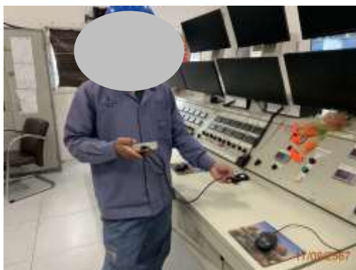
รูปที่ 3.4-9 การตรวจวัดค่าความเข้มของแสงสว่างในสถานประกอบการ
